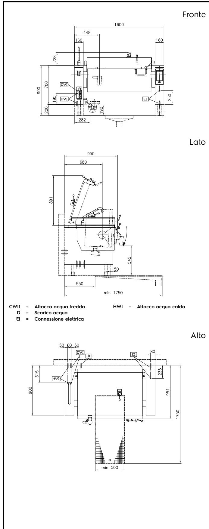
Brasiera elettrica basculante a pressione, 170 lt. (h), con funzione condensa vapore e sonda di temperatura, carico automatico acqua calda/fredda con rubinetto, doccetta, kit di chiusura posteriore.
